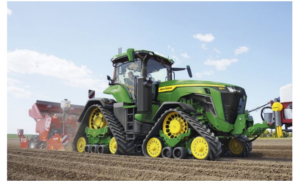
Het poten en aanaarden van de aardappelen gebeurt in één werkgang.
