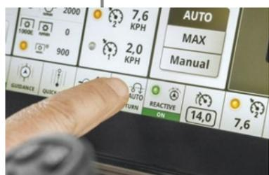
Activez ou désactivez aisément le système de direction réactive grâce au CommandCenter™ afin de répondre à vos préférences de conduite ou à votre application.
